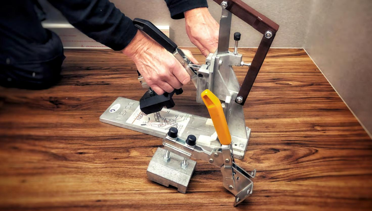
Die Stützböcke erleichtern die Auflage und begünstigen dadurch die Sauberkeit des Durchschnichts (bei der EP 60/13 flex life, Cubu flex life Serie, Hamburger Stil) Kernsockelleisten mit dünnem Kern werden ohne Stützböcke gestanzt.
