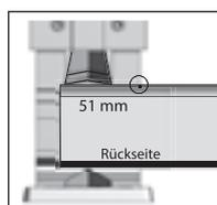
Dann das Profil mit der Markierung deckungsgleich an die Kanter der Anschlagfläche anlegen. Die Spannvorrichtung betätigen und Außen-decke stanzen.
