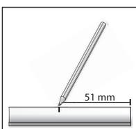
Am Ende das Profil 11 mm überstehen lassen. Vom Ende 51 mm zurückmessen und eine Markierung am Profil anbringen.
